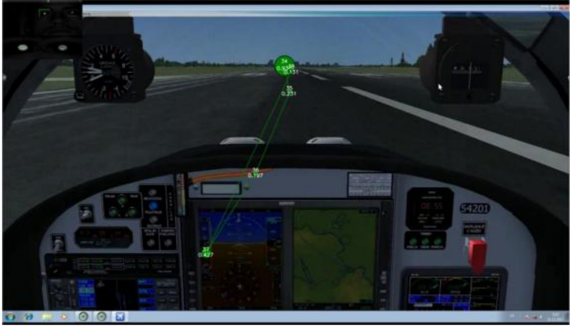
Şekil 10. Katılımcı P5'in kalkış aşamasına ait kaydı. 3 saniyelik bakış grafiği. Daha küçük yarışpa sahip ve dolayısıyla daha kısa süreli sabitlenmeler (Yeşil daireler) mevcut. AST AOI'den OC AOI'ye geçişler (sakkadlar) gözlemlenmiştir.
