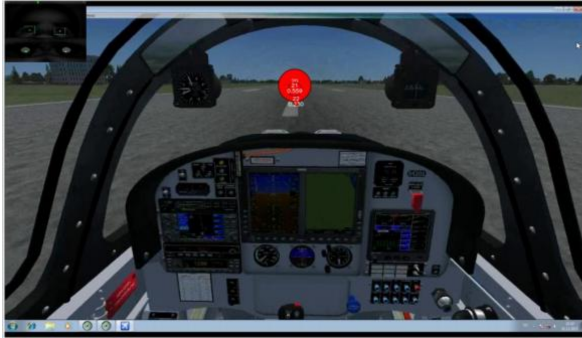
Şekil 11. Katılımcı P7'nin kalkış aşamasına ait kaydı. 3 saniyelik bakış grafiği. Daha büyük yarışpa sahip ve dolayısıyla daha uzun süreli sabitlenmeler (Kırmızı daireler) mevcut. AST AOI'den OC AOI'ye (veya tam tersi) geçişler (sakkadlar) mevcut değildir.
